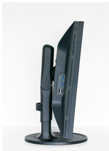
Angolo massimo di inclinazione in avanti
