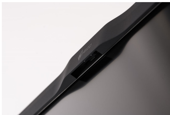
Sporgenza per la sonda di calibrazione integrata
